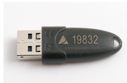
Abb 2: Rockey4 ND (Keine Treiber benötigt) Hardwarelizenzschlüssel (Dongle)
