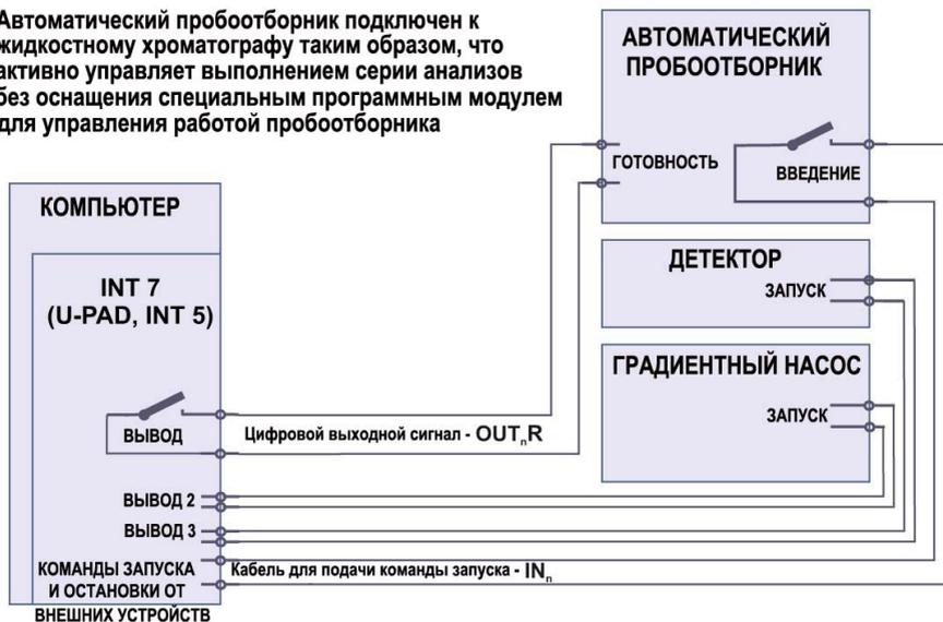
Рисунок 21: Подключение кабелей к жидкостному хроматографу, оснащенному автоматическим пробоотборником
