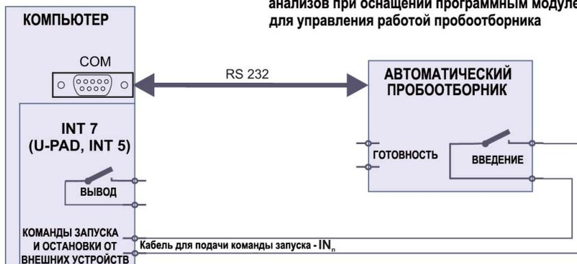
Рисунок 23: Подключение автоматического пробоотборника с программным модулем, управляющим его работой, + аналого-цифровой преобразователь
