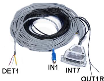
Рисунок 3: Стандартный набор кабелей для системы, нуждающейся в аналого-цифровом преобразователе
