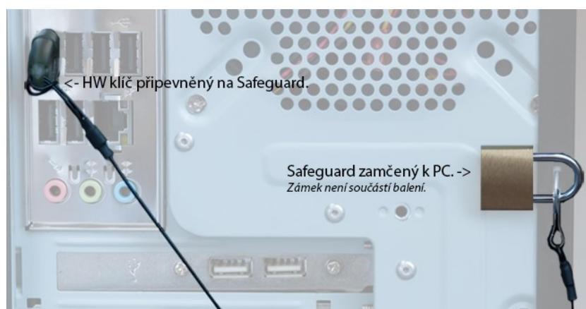
Safeguard připevněný zámkem k poutku na zadní straně PC.
